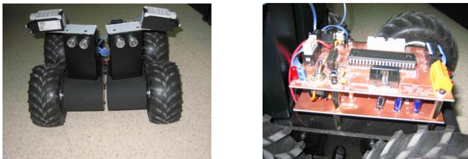
Figura 1. Imágenes de RoboTeruel: izquierda, visión frontal; derecha, placa del microcontrolador
